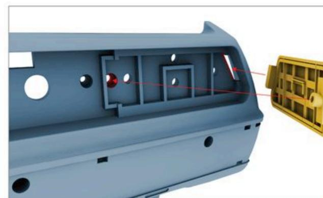
**ÉTAPE 2** >> Placez le cadre assemblé dans la cavité droite de la partie arrière. Insérez d'abord la languette en plastique du cadre avant d'encaster le reste de la pièce.
