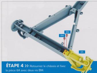
**ÉTAPE 4** >> Retournez le châssis et fixez la pièce 6A avec deux vis BM.
