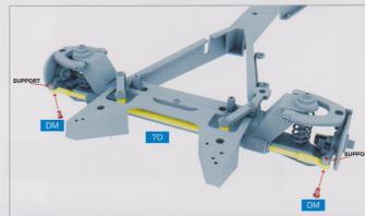
**ÉTAPE 3** >> Fixez la pièce 7D aux supports des pièces 5A et 6A avec deux vis DM.
