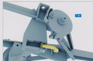
**ÉTAPE 8** >> Placez le disque de frein dans le porte-moyeu et remontez la bielle à l'intérieur de la partie basse du disque.
