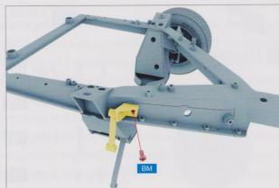
**ÉTAPE 3** >> Fixez l'équerre sur le côté du châssis avec une vis EM.
