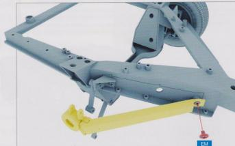
**ÉTAPE 4** >> Placez le trou situé à l'extrémité de la bielle de poussée sur le picot se trouvant sur le côté du châssis. Insérez une vis EM pour maintenir la pièce en place.
