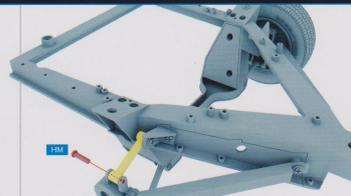
**ÉTAPE 5** >> Mettez l'extrémité de la bielle entre les deux montants du porte-moyeu arrière et insérez une vis HM dans les trous alignés.
