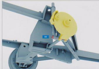
**ÉTAPE 9** >> Insérez la vis IM dans le porte-moyeu, le disque de frein et la bielle. Vissez-la pour maintenir le tout en place.
