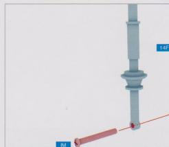
**ÉTAPE 7** >> Passez la vis IM à travers le trou situé au bas de l'amortisseur (14F).
